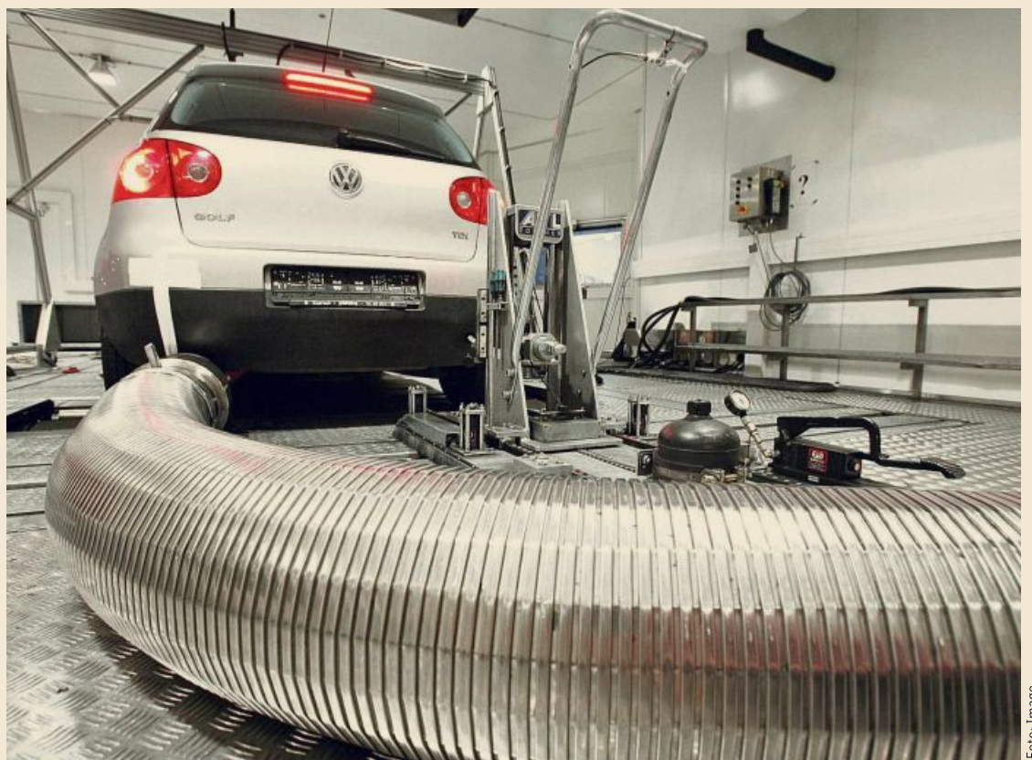
Alleinige Abgastests am Prüfstand gehören der Vergangenheit an. Ab sofort werden auch Emissionen direkt am Auspuffrohr im Straßenverkehr gemessen. Das soll realitätsnähere Werte bringen.
