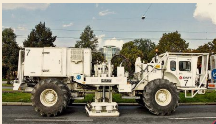
Seismik-Messgeräte der Münchner Stadtwerke im Einsatz: Ziel ist es, ein Abbild des Untergrunds anzufertigen.
